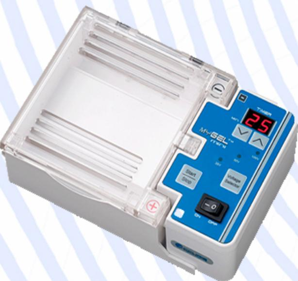
La tapa de seguridad tiene ventilación para ayudar a disipar el calor generado durante la electroforesis y cuenta con un área de visualización sobre el gel.
